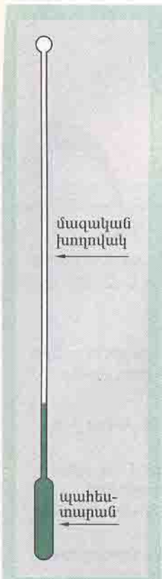
Նկ. 87 Հեղուկային ջերմաչափի հիմնական մասը՝ պահեստարանը և նրան միացած մագակալան խողովակը
