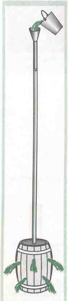
Նկ. 103 Պասկալի փորձը: Երբ խողովակում ջրի մակարդակը հասնում է որոշակի բարձրության, տակառի կողմնային պատերը ճաքճքվում են, և ջուրն արտահոսում է տակառից
