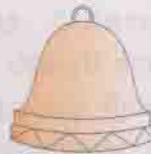
Նկ. 1.4. Չանգի պատրաստումը ձուլման եղանակով
